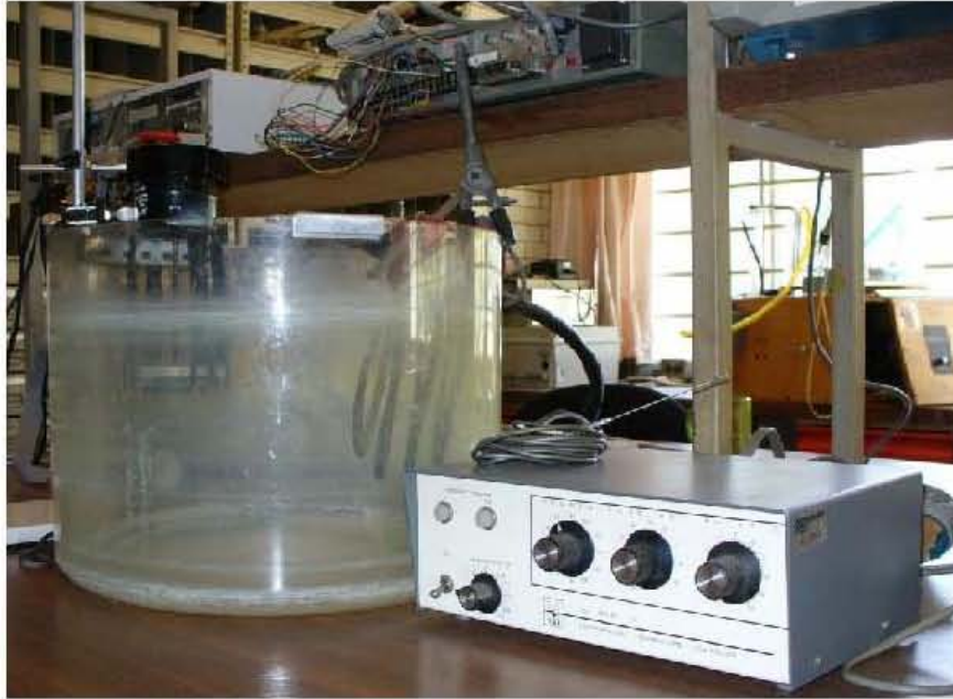
Figura 4.1. Cuba de agua para calibrar sensores de temperatura.
