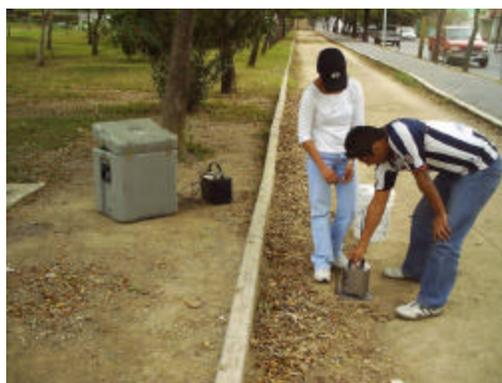
Figura 67. Equipos usados en la observación de microtremores. En el lado izquierdo, en la caja gris se encuentra el sistema de adquisición digital Reftek, junto a la caja se encuentra el acumulador que provee de energía tanto al
