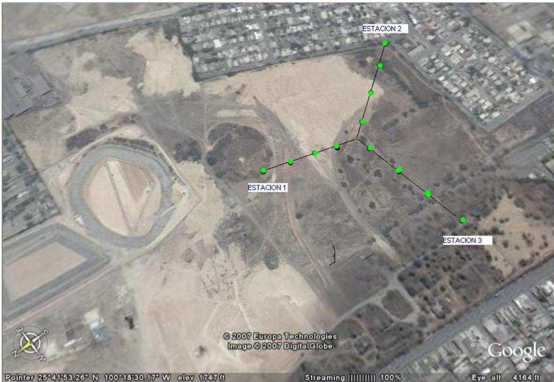
Figura 4. Esquema de los arreglos realizados en el predio cercano al Centro de la ciudad de Monterrey Nuevo León.
