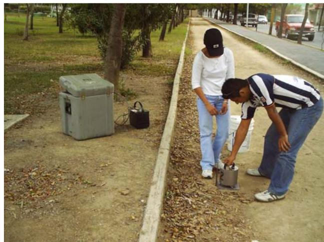
Figura 5. Equipos usados en la observación de microtemores.
