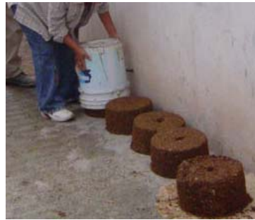
Foto 24. Vaciado del bloque sobre el piso.
