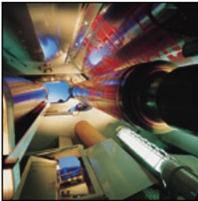
El sistema de impresión flexográfico es directo, esto quiere decir que la plancha flexográfica una vez entintada, transfiere directamente la tinta al soporte, por ello cuando vemos esta plancha observamos que los textos de la imagen se leen al revés para que en el soporte impreso se lean correctamente.
