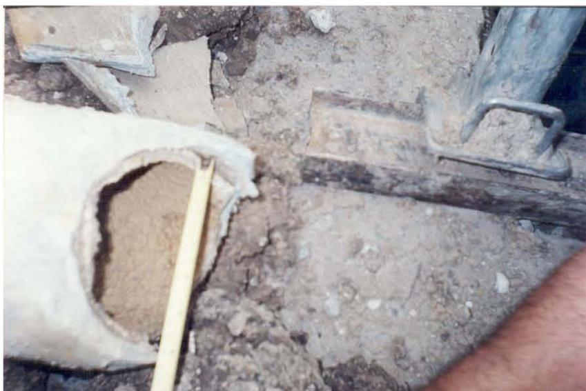
Fotografía 2.8 Grado de incrustación de algunas de las tuberías de la ciudad causada por la acumulación de sales.
