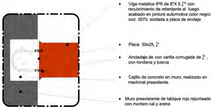
Detalle anclaje de vigas en mechnal
