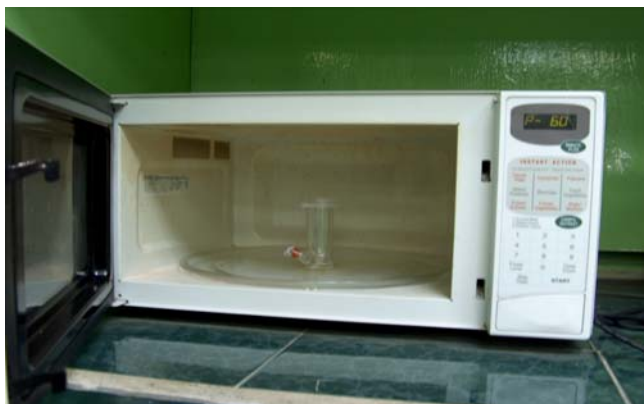
Figura 4.4.2 Reacción de polimerización en vaso Dewar adaptado para inyección de nitrógeno con horno de microondas
