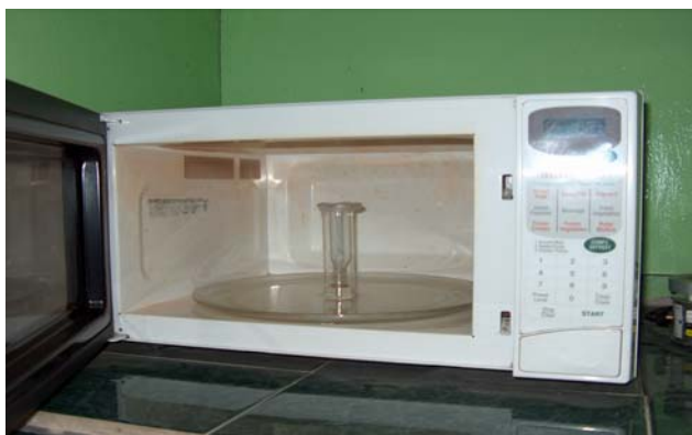
Figura 4.3.2 Reacción de polimerización en vaso Dewar con horno de microondas
