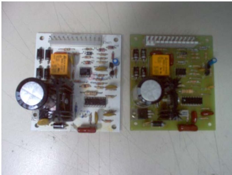
Fig. 2.4.1 Comparación de Tarjetas, de producción es la de color verde y repuesto de color blanco.
