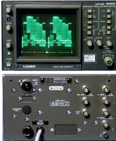
Fig. 7.33. Monitor forma de onda marca Leader.
