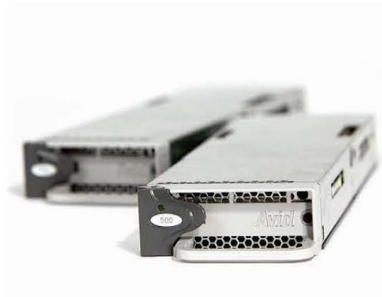
**Fig. 7.58. Discos duros (storage blades) sistema Isis, cada uno con 2 discos internos de 500 GB y procesadores independientes funcionando como computadoras individuales.**
