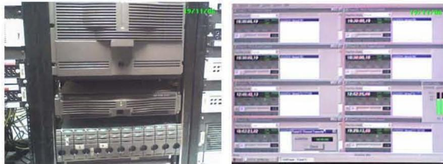
**Fig. 7.50. Videoservidor Grassvalley Profile XP 1100 e interfaz de captura/reproducción**
