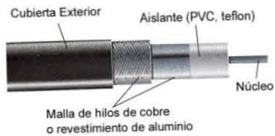
**Fig. 7.39. Elementos del cable coaxial**
