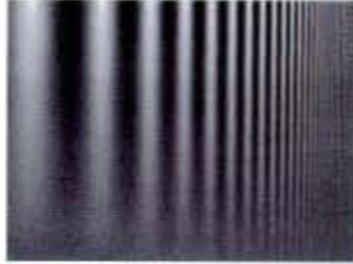
**Fig. 1.11. Patrón que incrementa la frecuencia de izquierda a derecha y decrementa el contraste de arriba abajo**
