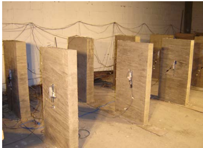
Figura 2.12 Losas coladas y transductores de desplazamiento
