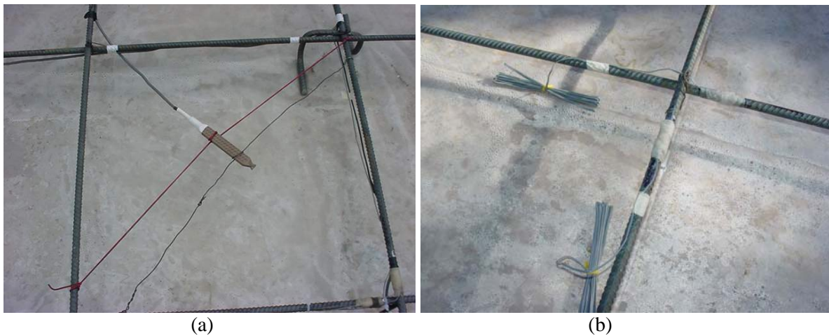
Figura 2.6 a) Deformímetro para mediciones en el concreto; b) deformímetro para mediciones en el acero
