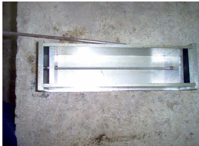
Figura 2.15 Molde de acero para prismas de concreto restringido
