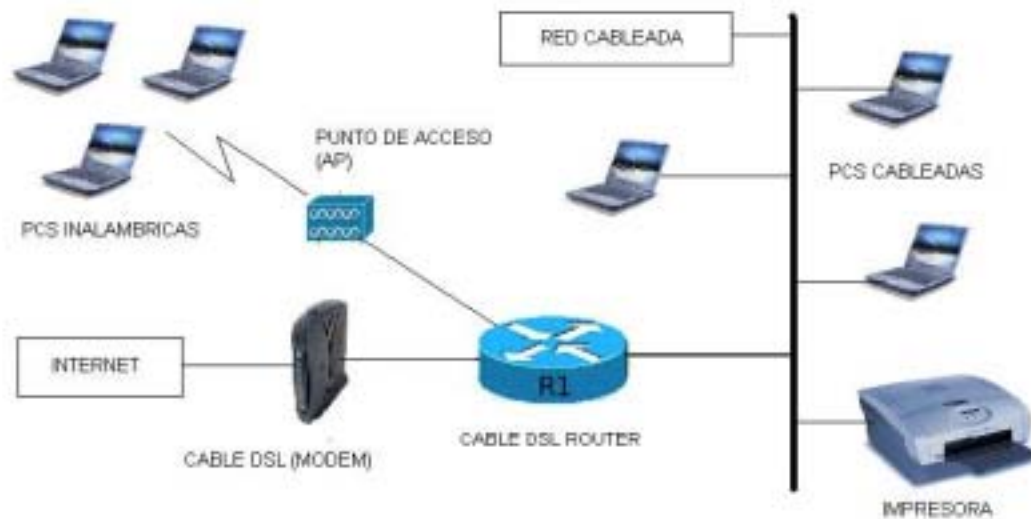
Figura 2.4 Red cableada con un AP y una estación de red inalámbrica
