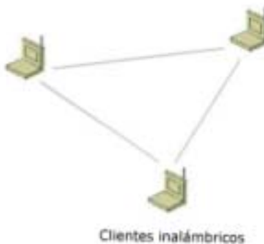
Figura 1.2 Red inalámbrica en modo ad hoc
