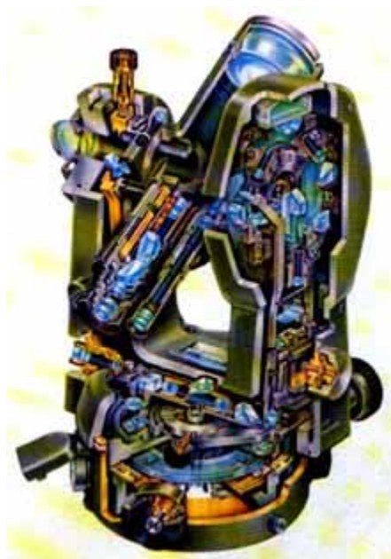
Fig. 2.1 Dibujo de corte del teodolito Kern DKM2-A 12 .
