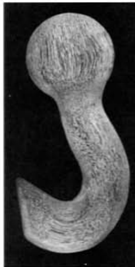
Figura 1.3 Líneas de flujo en un gancho de acero 4340 (ASM International, 1988)
