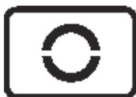
Medición *de área parcial*. Mide solamente un área muy reducida 10 %, usualmente al centro del visor para realizar lecturas aisladas entre valores distintos.
