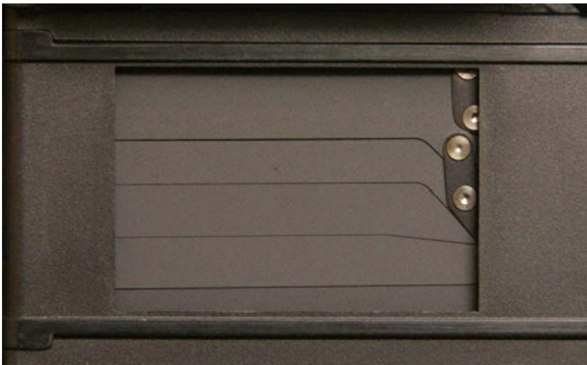
Fotografía del obturador Canon, mostrando la disposición de las cortinillas
