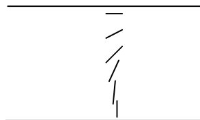
Figura 4.2 Configuración inicial de las partículas de cristal líquido, debido a la alineación híbrida.
