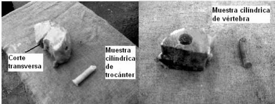
Figura 3.7 Foto que describe las probetas cilíndricas en fémur y en vértebra.
