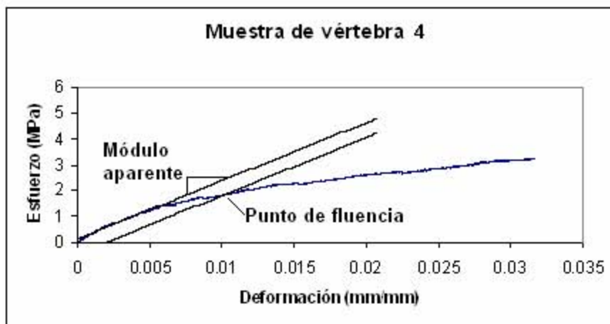
Figura 4.10 Gráfica esfuerzo-deformación para la muestra 4 de vértebra, indicando los parámetros mecánicos obtenidos.
