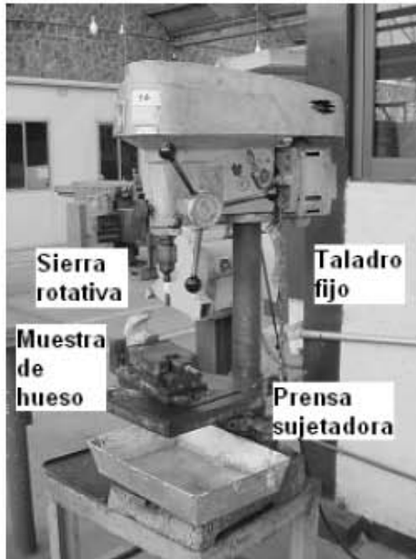
Figura 3.5 Foto que describe el procedimiento para realizar el corte de hueso esponjoso.
