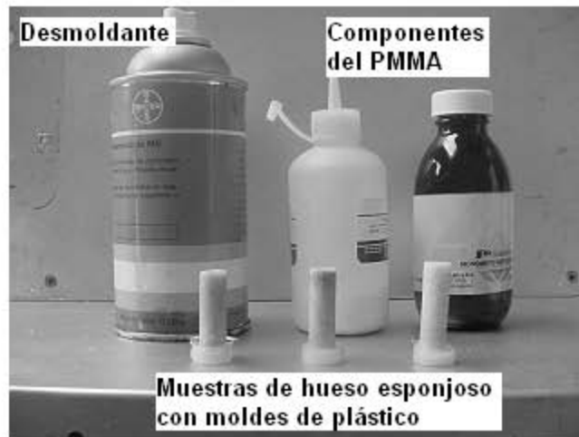
Figura 3.9 Foto que describe la colocación de PMMA en las muestras de hueso.
