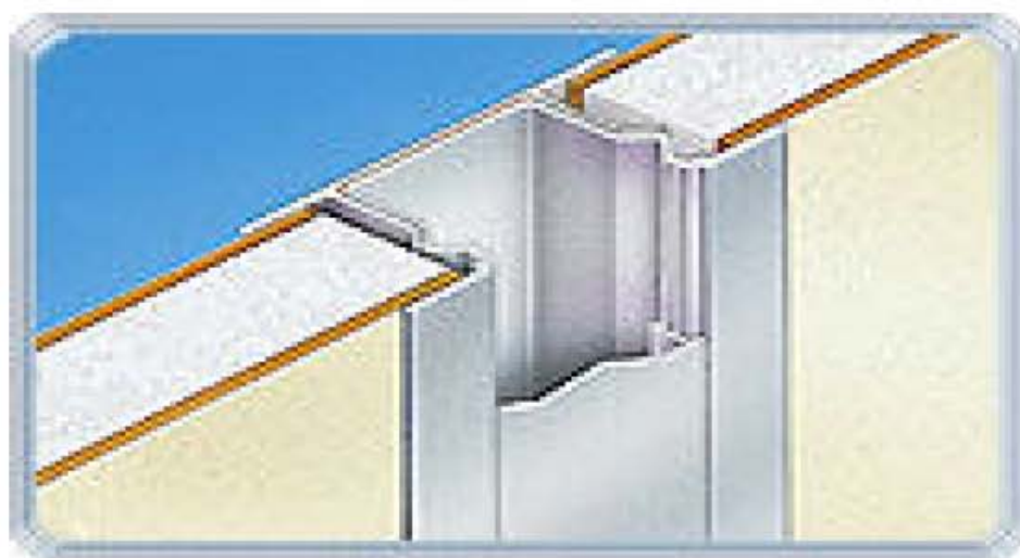
Figura 1. Junta estructural en muros
