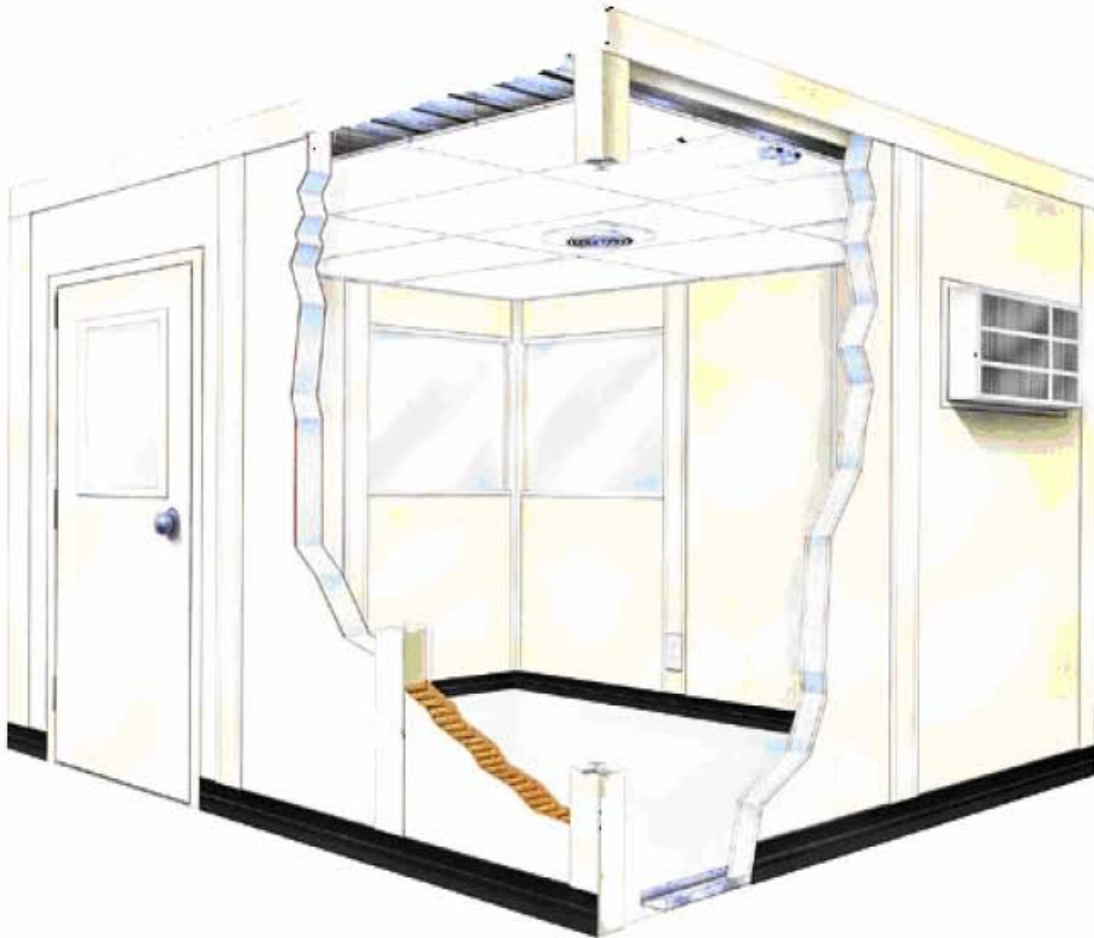
Figura 3.1.8 Esquematación de un cuarto construido con panel
