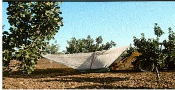
**Imagen 7:** Vibrador de paraguas en una plantación de pistacheros .
