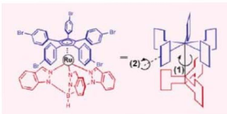
Figura 14. Torniquete molecular organometálico, se muestra la rotación a lo largo del eje de rutenio (1) y la rotación de los anillos fenilo (2). La rotación de (2) ocurre perpendicularmente al centro metálico
