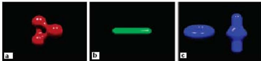
Figura 11. Partes que constituyen un rotor molecular. a) Núcleo b) eje y c) estator
