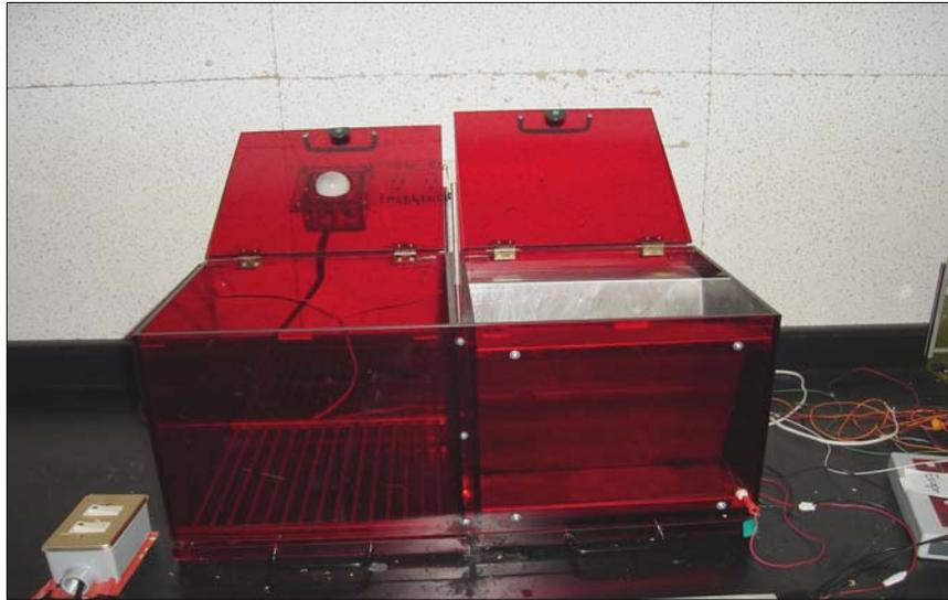
Figura 8. Cámara de evitación inhibitoria. A la izquierda se ubica el compartimiento, “de seguridad”, iluminado por un foco colocado en la tapadera del compartimiento y con una rejilla en el piso. A la derecha el compartimiento “de castigo”, es relativamente oscuro y sus paredes laterales tienen forma de V, las cuales llegan al piso del compartimiento.
