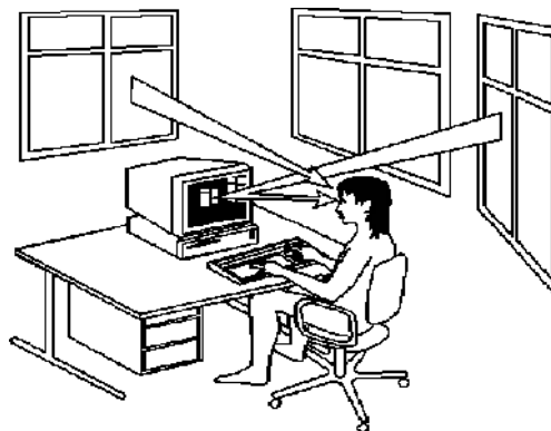
Figura 3.3.1. Las fuentes de luz deben evitar la aparición de reflejos en la pantalla del ordenador o los deslumbramientos. 2
