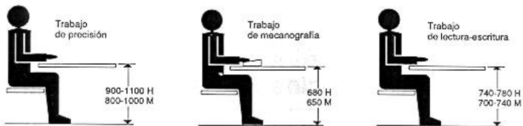
Fig. 4.2.5: Altura del plano de trabajo para puestos de trabajo sentado (cotas en mm) 1
