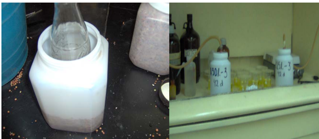
Figura 10. Compactación de los microsilos con una botella de fondo plano y extracción de aire con la bomba de vacío
