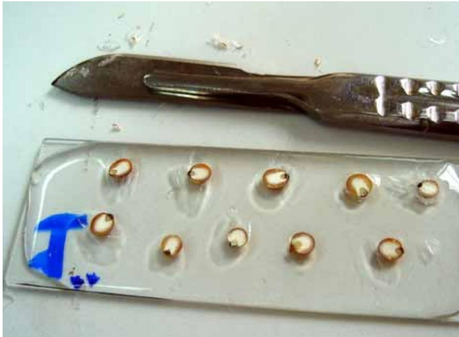
**Figura 5.** Fotografía de portaobjetos con granos de sorgo fijados con resina epóxica y cortados con bisturí.
