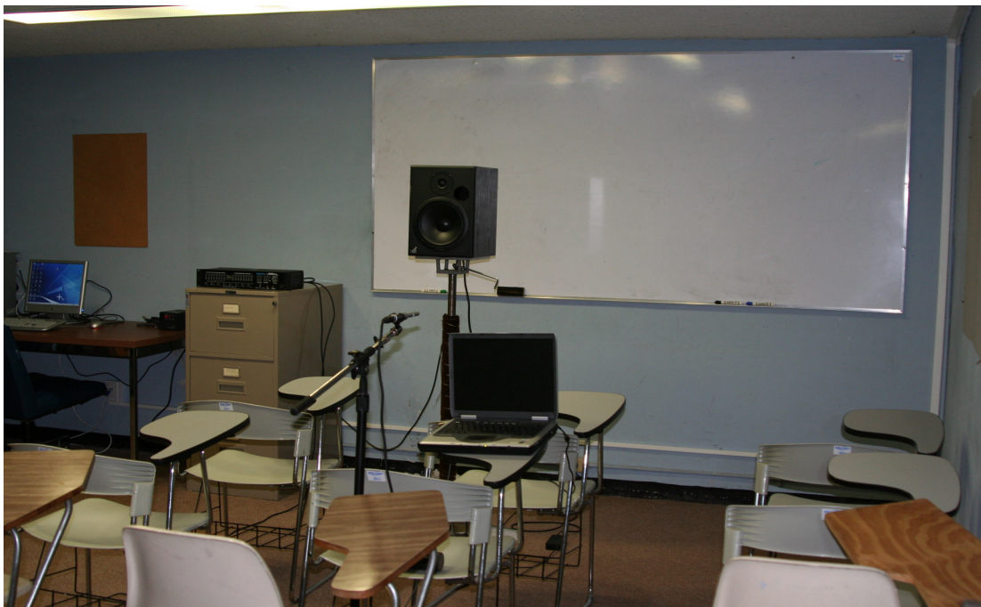
Figura 4.2: Vista del salón de clases donde se llevaron a cabo las mediciones y distribución del equipo. Altavoz al frente en la posición del orador, laptop y micrófono en la posición 5.
