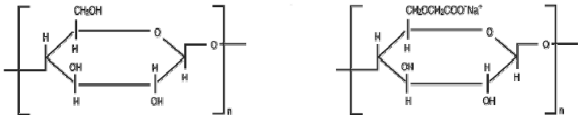
Figura 6. Estructura de la molécula de celulosa, la cual está compuesta por una cadena de repetidas unidades anhidroglucósidas, donde n representa el número de unidades en la cadena y se conoce como el grado de polimerización de la celulosa (DP). Cada unidad anhidroglucósida contiene tres grupos hidroxílicos. Del lado derecho se observa la CMC, que se obtiene sustituyendo uno de los hidrógenos de estos hidróxilos por grupos carboximetílicos (Coffey, 1995)
