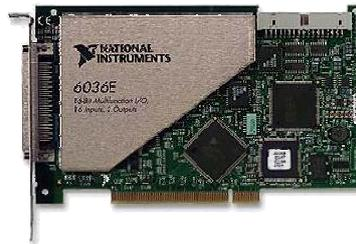
Figura 1: Tarjeta de adquisición de datos 6036E
