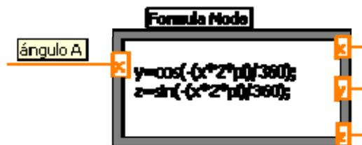
Figura 3.24: Ecuaciones del Triángulo de potencia
