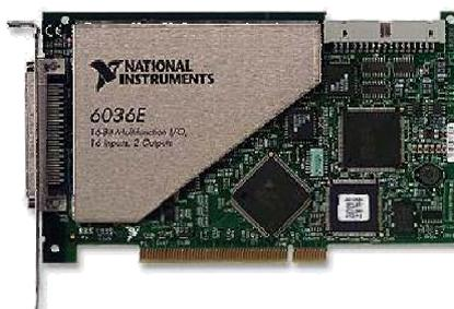
Figura 2.3: Tarjeta de adquisición de datos 6036E
