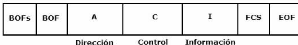
Figura II.24. Formato de un paquete de datos en IrDA.
