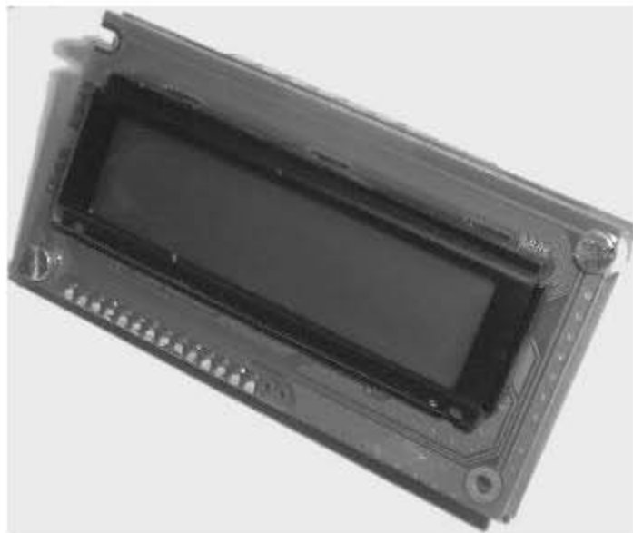
Figura III.10. Visualizador alfanumérico de 2 líneas X 16 caracteres.
