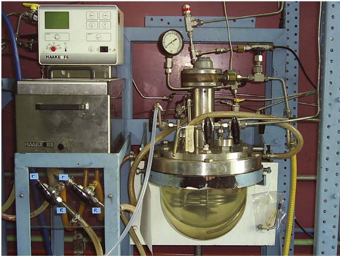
Figura 4.1 Reactor de polimerización aniónica.
