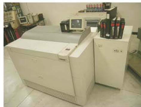
3.1.4f Esta maquina puede producir los negativos o positivos, lo que se hacia de manera tradicional con las cámaras en fotolito
