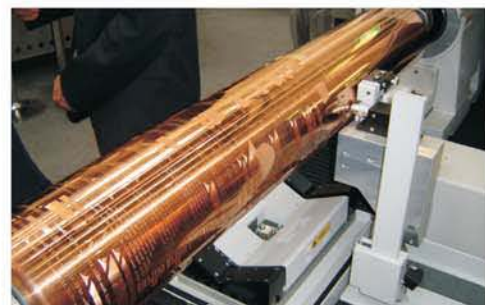
3.3c Rodillos grabados por medio de un ordenador
