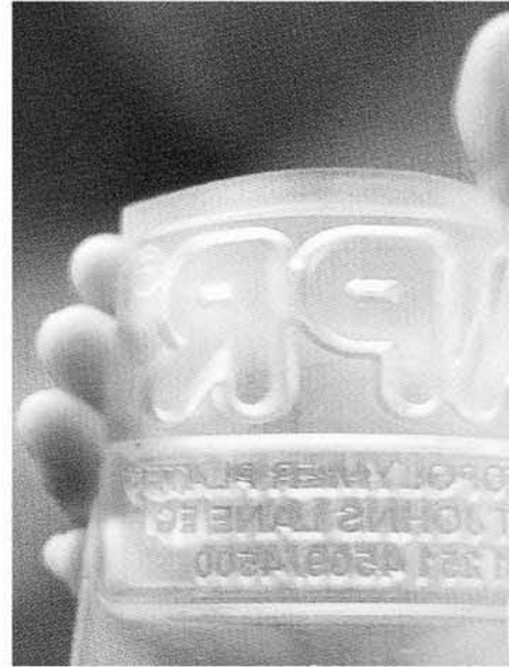
3.2.1a Clisé realizado a partir de un negativo, la imagen aparece en relieve.
