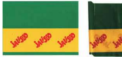
3.3.3b Sello de garantía impreso a tres tintas, plasta en PVC. Se puede observar el dummy digital de lado izquierdo y el sello impreso como producto terminado en el lado derecho
