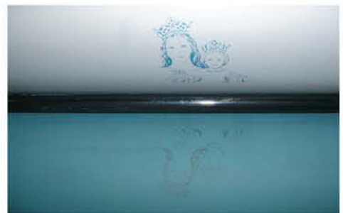
3.4.2.a Se puede observar la lamina montada, el método de impresión es indirecto y planográfico
