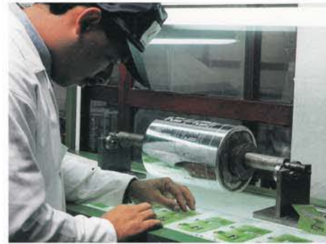
3.3.1a Rodillo cromado y con la imagen trasladada, se observa al jefe de producción chequeando que el rodillo este en buenas condiciones.
