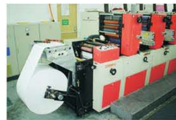
3.1.4c prensas de offset, existen maquinas de una a seis cabezas, cada cabeza permite imprimir una tinta, una maquina de seis cabezas imprime seis tintas al mismo tiempo. También se puede observar una prensa de flexografía.
