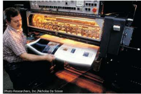
1.4a Impresión en offset El operador recibe una página terminada procedente de una imprenta offset de seis colores. La impresión offset, o litografía, es la técnica de impresión más utilizada en la fabricación de libros, revistas y periódicos.
