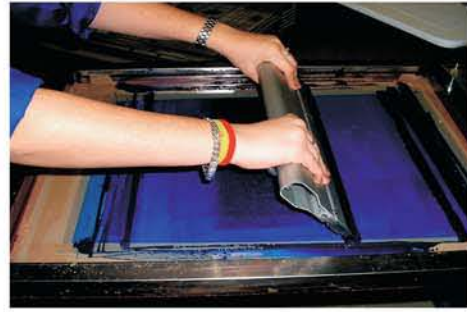
3.5.3a La serigrafía nos permite imprimir en sustratos planos o colíndricos, además de que los materiales son variados: vidrio, tela, papel, etc.
