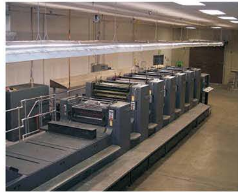
3.4.2b Hay prensas de hasta seis cabezas, pueden imprimir selección de color, más colores adicionales e impresión por ambos lados.
