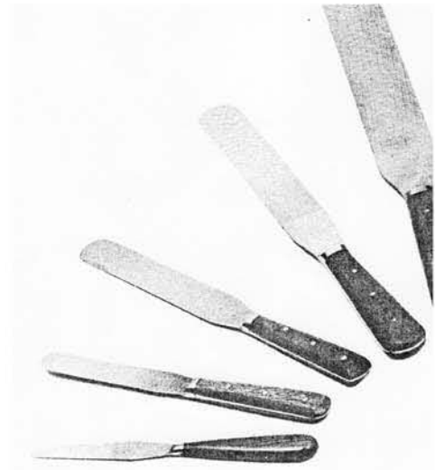
3.5e Con ayuda de la espátula ayudamos a que la tinta tenga fluidez con vinadola con solventes especiales.
