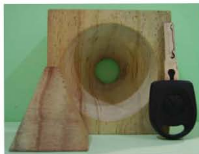
Fig. 4.3 Maniquí de madera. Se observa la pirámide y la base en forma de prisma rectangular, en la que se ha maquinado una perforación cónica en donde se inserta la pirámide. La llave se colocó con fines de referencia.
