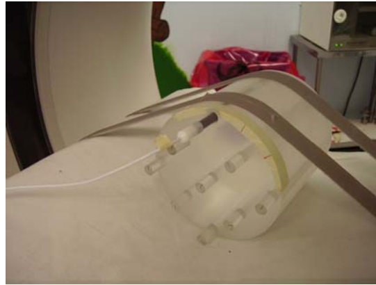
Fig. 3.3 Maniquí dosimétrico con cámara de ionización en posición superior.
