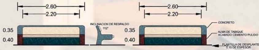
(10) BANCA DE CONCRETO
