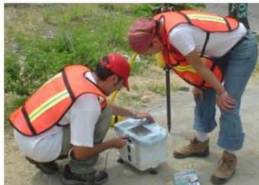
Figura 4.7. Gravímetro Graviton EG en operación de campo.
