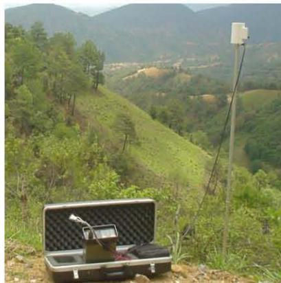
Figura 4.2. Magnetómetro Geometrics G-856 en operación de campo.
