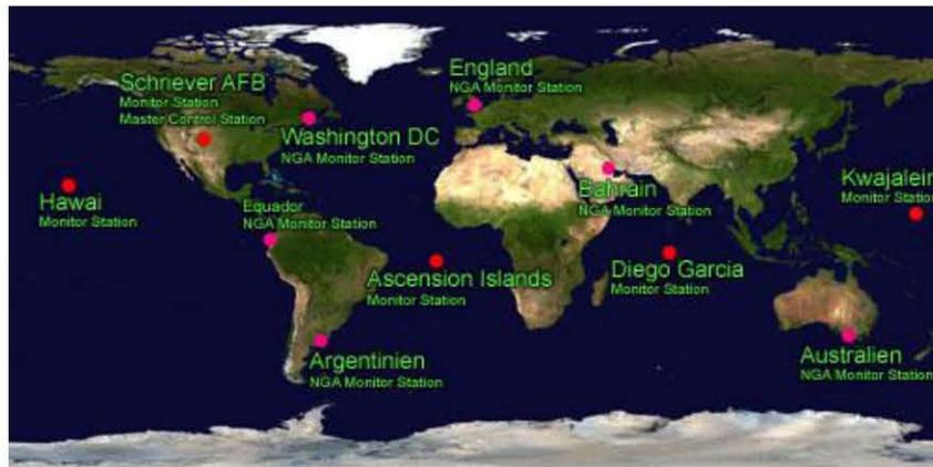
Figura 3.9. Localización de la estación de control (*Master control, MC*) y distribución de las estaciones de monitoreo (*Monitor Station, MS*) ([www.kt.agh.edu.pl](http://www.kt.agh.edu.pl)).
