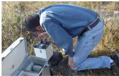
Figura 4.6. Gravímetro Modelo G de LaCoste and Romberg en operación de campo.
