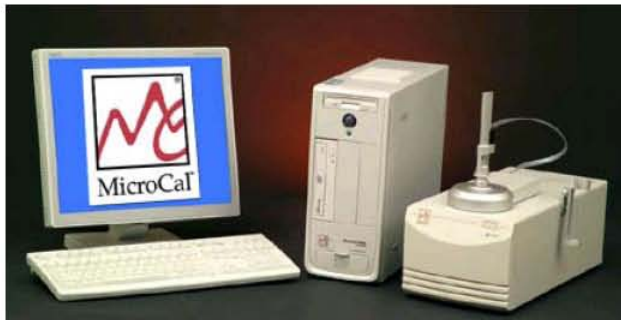
Figura 5. Sistema de Calorimetría de Titulación Isotérmica. A: Equipo de para realizar ITC. B: Diagrama del instrumento para ITC. Antes de incorporar la jeringa a la celda se introdujo el ligando y se purgó para eliminar la presencia de burbujas que pueden interferir en el experimento. Para obtener una línea base, la jeringa se mantuvo en agitación constante durante la calibración así como en el experimento.
