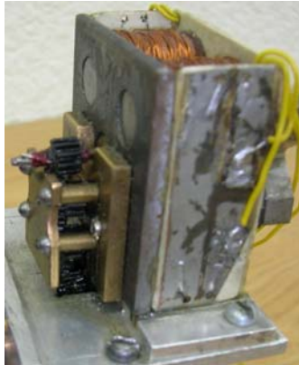
▲ Figura 1.4. Motor a pasos del husillo del MCM. Este motor tiene mayores dimensiones a las de los motores de los ejes. Así mismo tiene mayor par, consumo de corriente y de voltaje.
