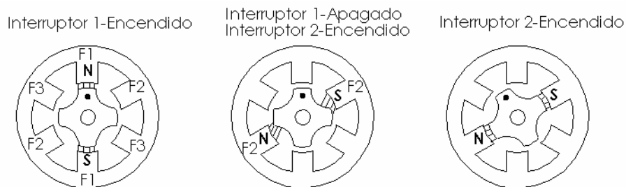
▲ Figura 1.9. Transición del rotor en función del flujo magnético generado en los polos.
