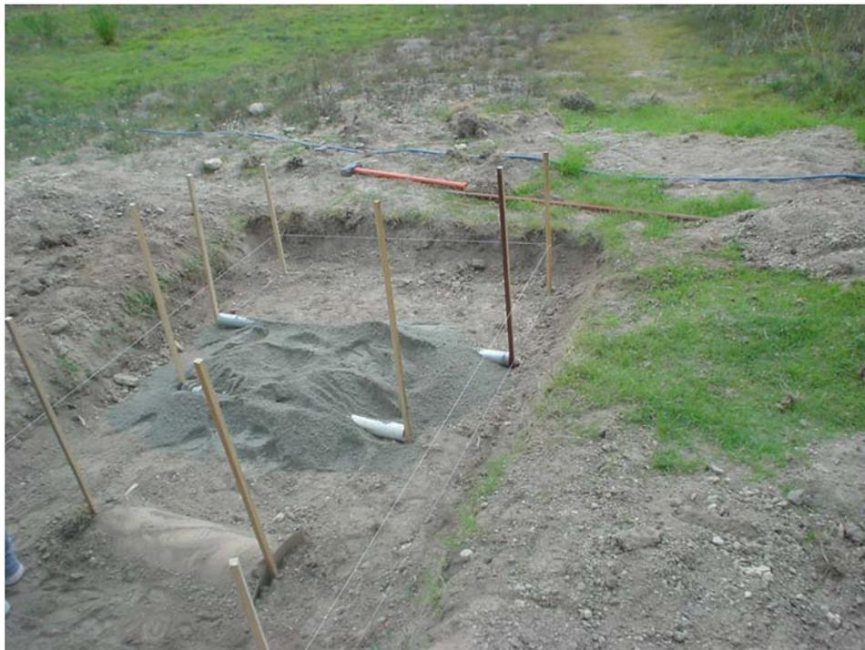
*Figura 5.14 En las fotografías se muestra la realización del experimento de campo. En la fotografía superior se observa la capa inferior de arena, en la fotografía inferior se ve la disposición de los tubos.*
