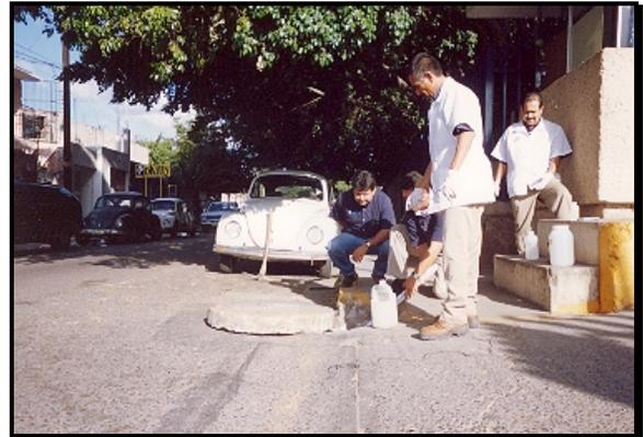
Muestreo simple o instantáneo, para que al término del período de muestreo, proceder a la conformación de la muestra compuesta
