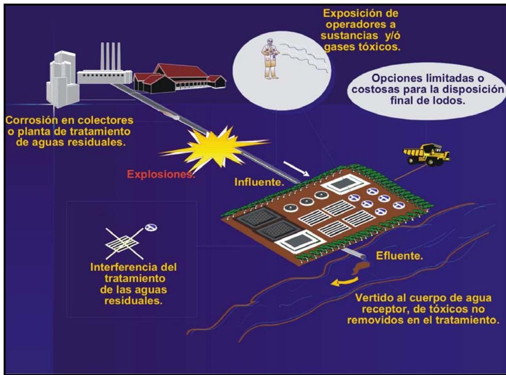
Figura II.3. Posibles impactos adversos por el vertido de contaminantes incompatibles al sistema de alcantarillado municipal y PTARM (CNA, 2003)
