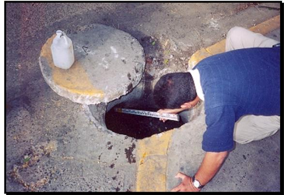
Medición del tirante de la lámina de agua, para proceder a calcular el gasto instantáneo
