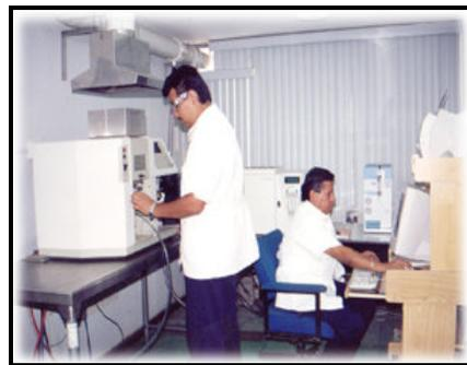
**Figura IV.10.** Espectrofotómetro de absorción atómica, para la determinación de metales pesados
