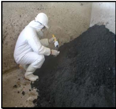
**Figura V.16. Muestreo aleatorio estratificado del lodo estabilizado**
