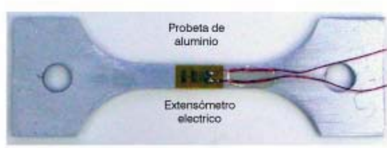
Figura 3.17: Probeta de aluminio con extensómetro eléctrico
