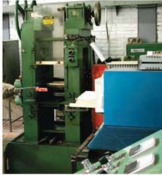
Figura 2.2: Laminado en caliente.
