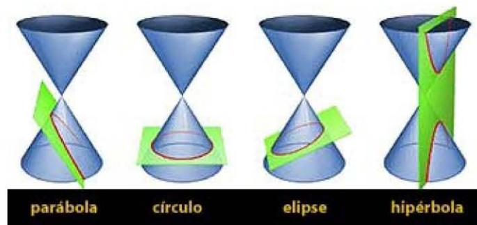
Si el plano secante es perpendicular al eje del cono, la curva resultante es una *circunferencia*. Si el plano es oblicuo respecto al eje del cono, pero corta a todas las generatrices, la curva es una *elipse*. Si el plano secante es paralelo a una de estas generatrices del cono, resulta una curva abierta llamada *parábola*, suponiendo el cono ilimitado. Por último si el plano secante corta a los dos mantos del cono, se obtiene la *hipérbola*, curva abierta que consta de dos ramas.
