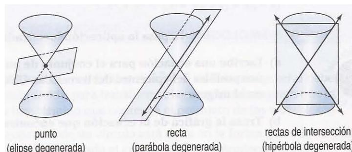
Si el plano pasa exactamente por el vértice del cono entonces tenemos un punto (elipse degenerada), si pasa por el mismo punto y además es paralela a la generatriz del cono entonces tenemos una recta (parábola degenerada), si dicho plano pasa por el vértice del cono y es perpendicular a lo que podríamos llamar base entonces tenemos dos rectas cruzadas ó rectas de intersección (hipérbola degenerada). Los casos anteriores dan origen a los casos de cónicas degeneradas.
