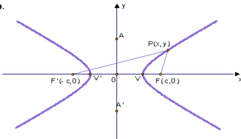
Los focos  $F$  y  $F'$  están sobre el eje  $x$ , el centro  $C$  es el punto medio del segmento  $FF'$  y las coordenadas de dichos puntos serán  $(c, 0)$  y  $(-c, 0)$  respectivamente, siendo  $c$  una constante positiva.
