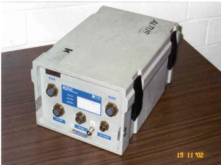
**Figura 7.** Acelerógrafo modelo K2
