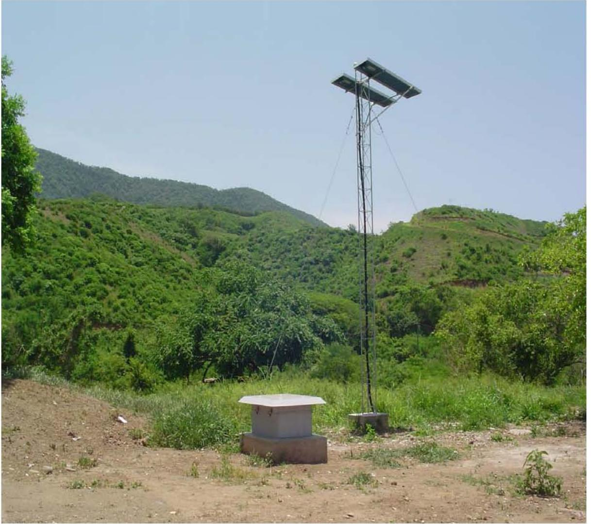
Figura 2.- Estación acelerográfica de la red del Instituto de Ingeniería
