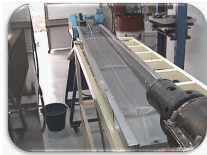
Figura. 26. Extrusión del polietileno injertado con MAH.
