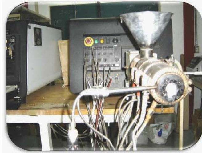
Figura. 25. Extrusor doble husillo donde se llevó a cabo el injerto de MAH sobre el polietileno
