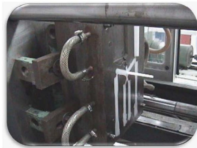
Figura. 30. Obtención de probetas para pruebas mecánicas procesadas por inyección.
