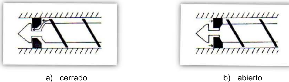
Figura. 17. Válvula de no retroceso (válvula check), abierta y cerrada
