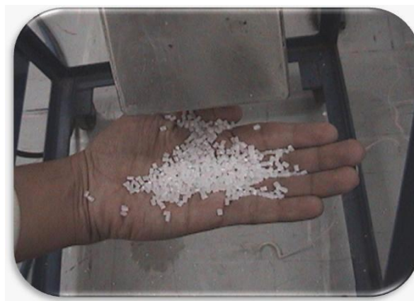
Figura. 28. Gránulos obtenidos de la extrusión del polietileno injertado con MAH y arcillas bentonitas, para su posterior inyección.
