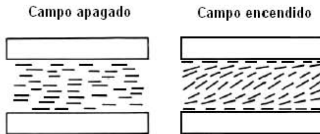
Figura. 1. 18. Transición de Fredericksz, para un alineamiento molecular homogéneo.
