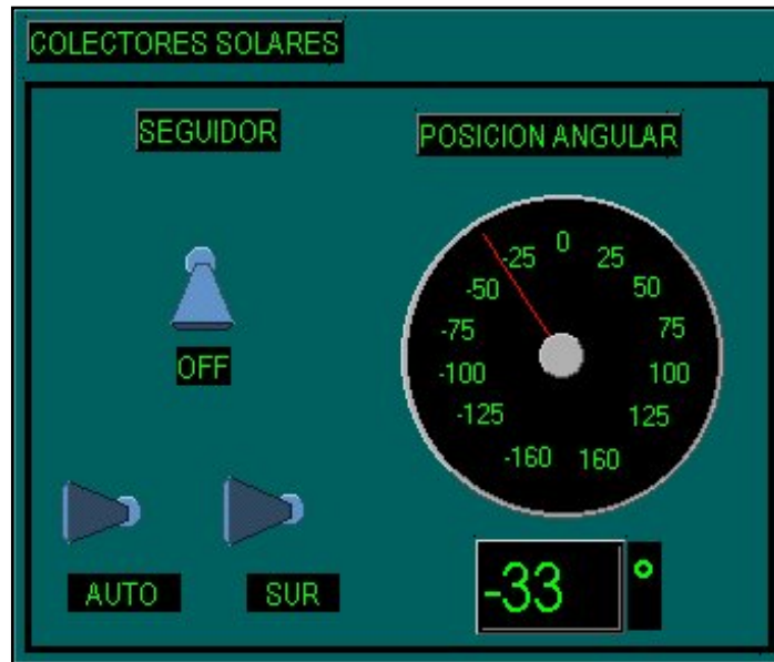
Figura 6.14. Panel de control de colectores.
