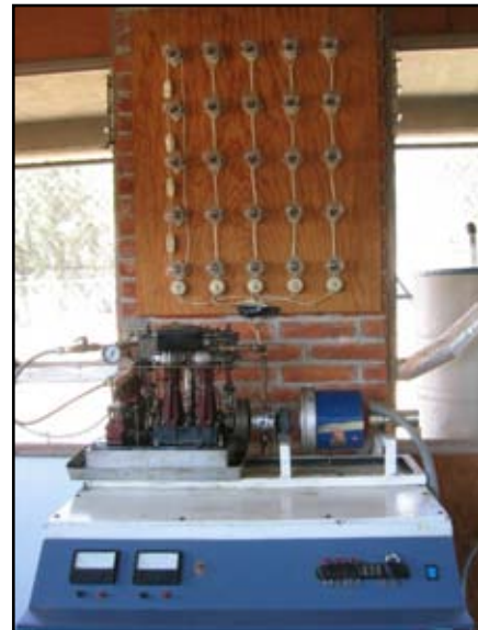
Figura 4.38. Bloque de generación y carga eléctrica.
