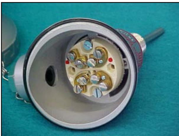
Figura 4.17. Conexiones del sensor.
