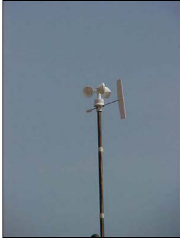
Figura 4.11. Sensor de viento.
