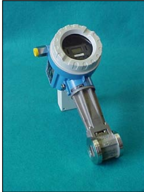
Figura 3.41. Transmisor de flujo tipo Vortex, con despliegue.
