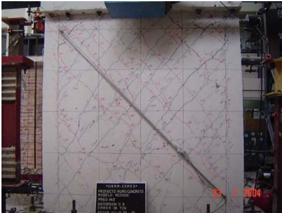
Figura 3.47. Punto de carga máxima del muro MCC100C
