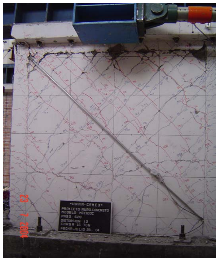
Figura 3.48. Estado final del muro MCC100C
