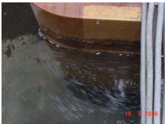
Fig. 5.19 Vórtices en la nariz de las pilas 1 y 2
