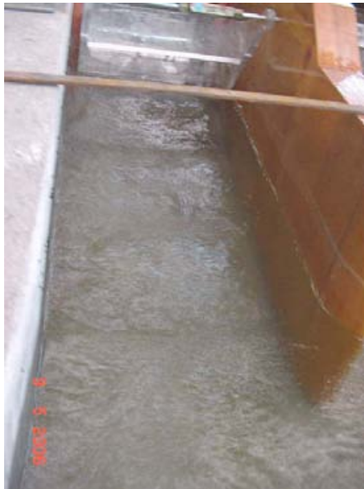
Fig. 5.14 Oscilación detrás de la compuerta.
