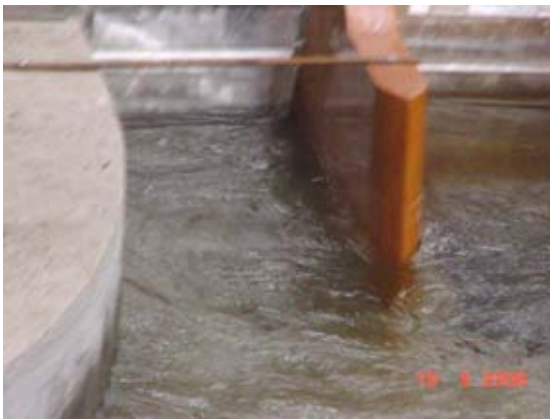
Fig. 5.21 Turbulencia detrás de la compuerta
