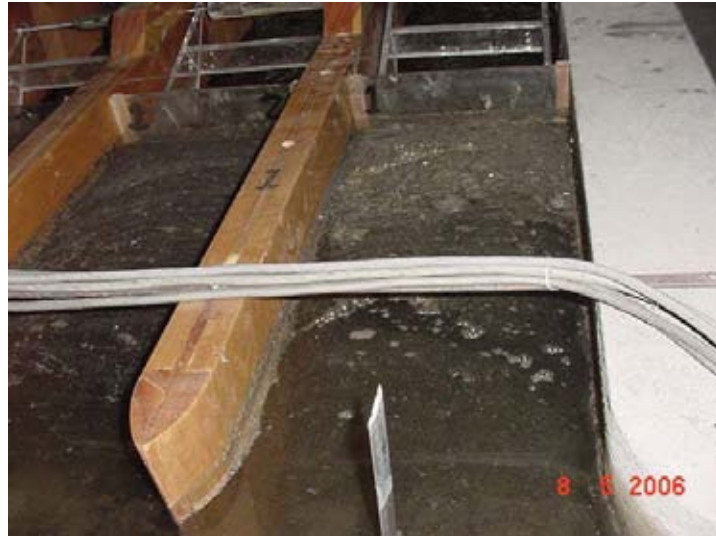
Fig. 5.11 Efecto de las pilas aguas arriba.
