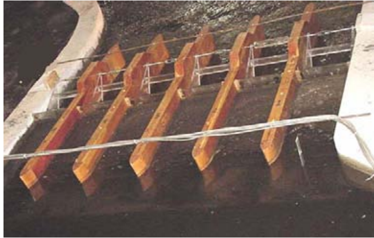
Fig. 5.1 Operación del modelo físico con 6 compuertas
