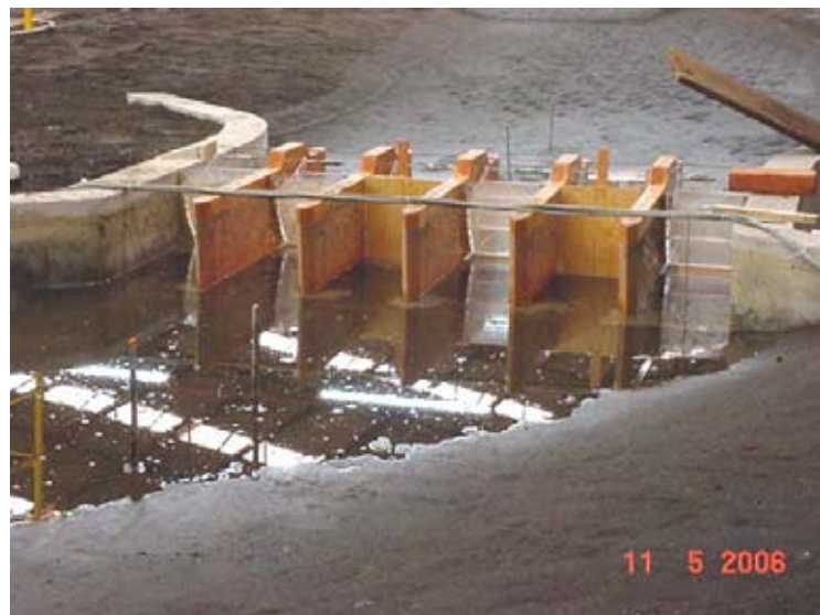
Fig. 5.2 Operación del modelo físico con 4 compuertas
