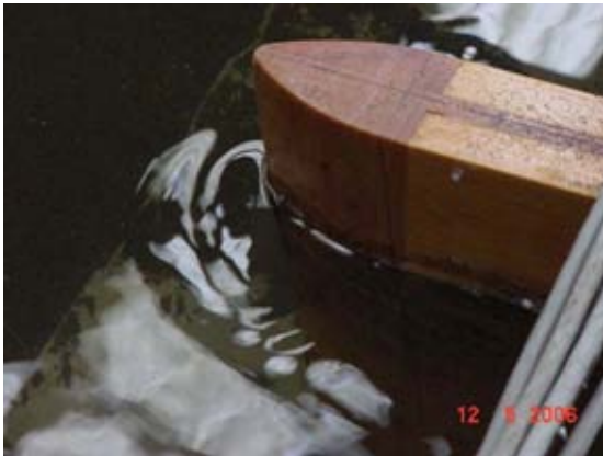
Fig. 5.15 Vórtices en la nariz de las pilas 1 y 2
