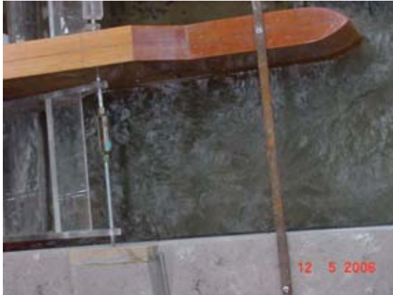
Fig. 5.17 Turbulencia detrás de la compuerta
