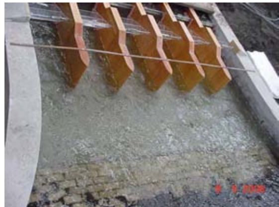
Fig. 5.13 Distribución de la corriente de agua a la salida de las pilas.
