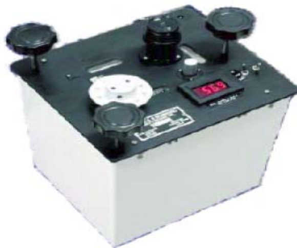
Figura 3.1.8. Gravímetro Lacaste & Romberg, modelo G.
