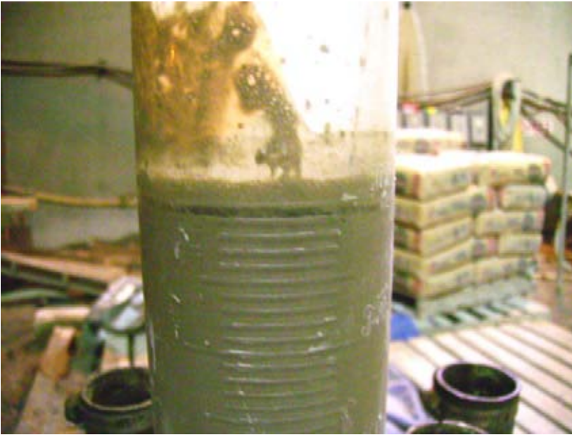
Foto 10. Prueba de Decantación
