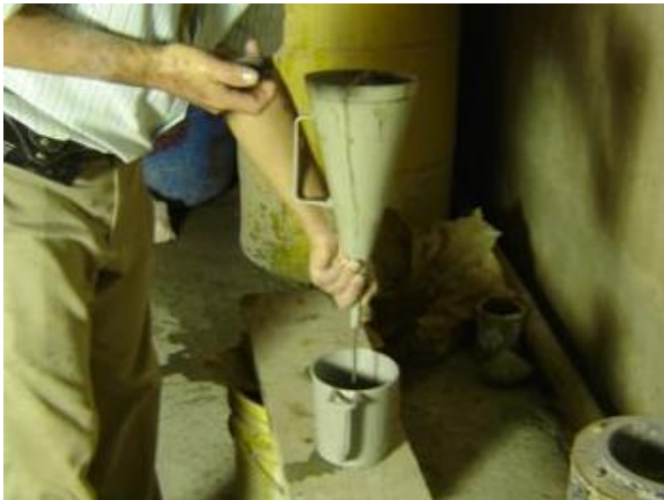
Foto 9. Prueba de Viscosidad
