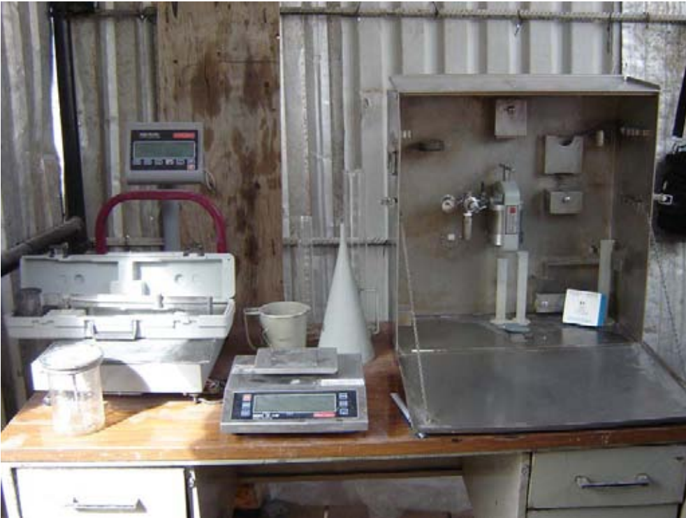
Foto 8. Equipo para pruebas de lechada de inyección
