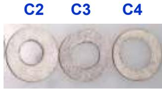
**Figura 3-3:** Colimadores de plomo de 2 mm de espesor, con 2 cm de diámetro exterior y diámetro interior variable utilizados en la radioterapia
