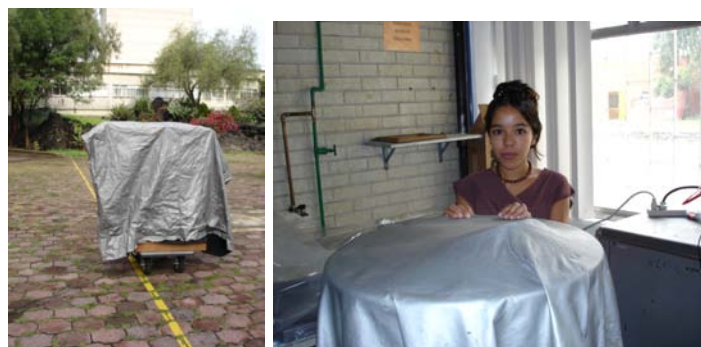
Figura 5.11: Segunda etapa, cubierta especial doble cara, de un lado plástico color metálico y por el otro lado de tela negra.
