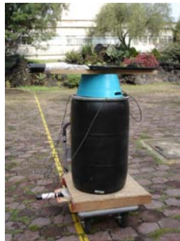
Figura 5.13: Configuración con centelladores, para medir el flujo de muones verticales
