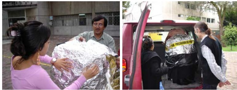
Figura 5.10: Primera etapa. Cubierta compuesta de 3 capas, primera capa con cortina negra, posteriormente plástico y finalmente aluminio
