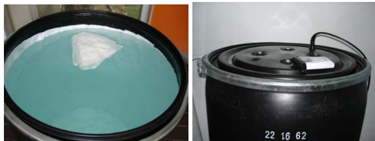
Figura 5.4: A la izquierda tanque abierto lleno de agua con capa de Tivek flotando, a la derecha tanque cerrado con cables acoplados.
