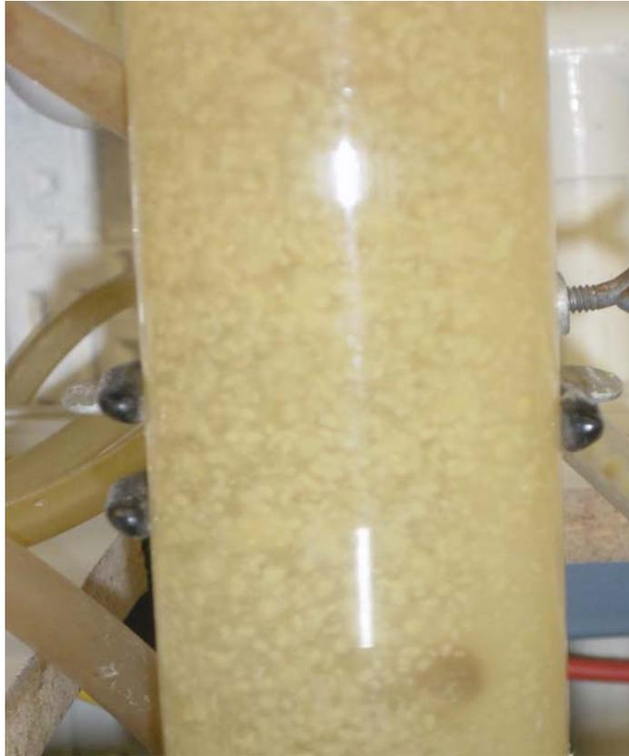
**Figura 5.14.** Imagen de los gránulos aerobios dentro del reactor
