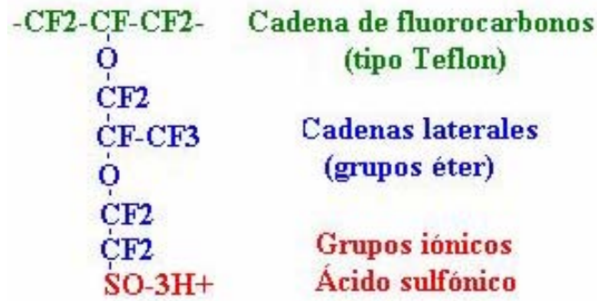
Figura 1.1 Estructura química básica de la membrana (Nafion 117).
